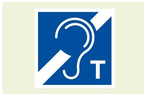
Symbol zur Kennzeichnung einer Induktionsschleifen-Anlage
